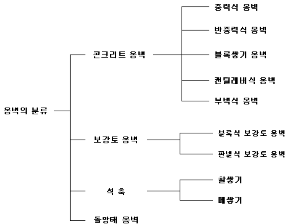
[그림 13.1] 재료형식에 따른 옹벽 분류
